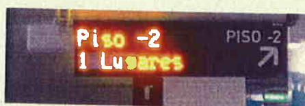
Painel de Lotação de Próximo Piso
